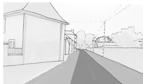
Croquis d'insertion du recalibrage de la voie.
