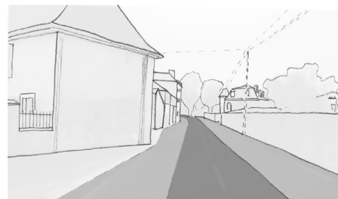
Croquis d'insertion du recalibrage de la voie.
